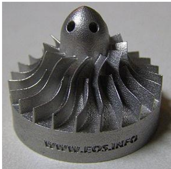
Obr.10 Turbína vyrobená z kovu pomocou 3D tlače
