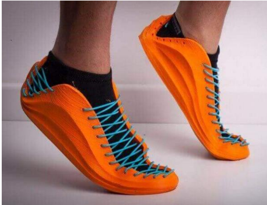
Obr.13 - obuv vytlačená na 3D tlačiarni
